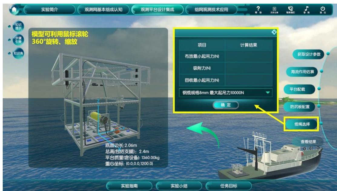
图18b 坐底观测平台缆绳选择
