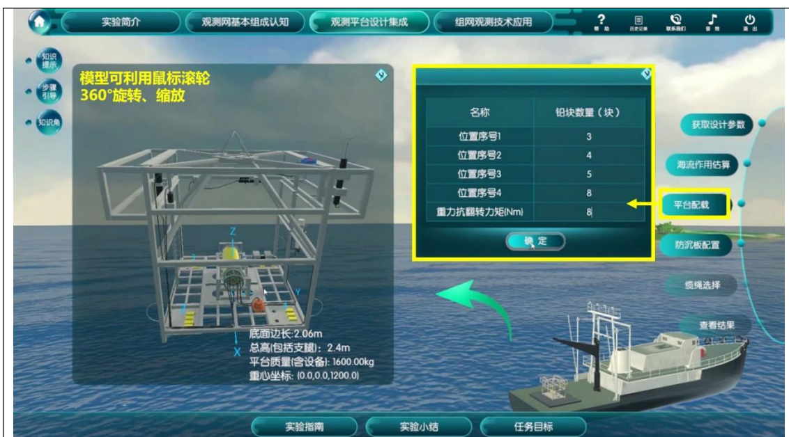
图16b 坐底观测平台配载设计
