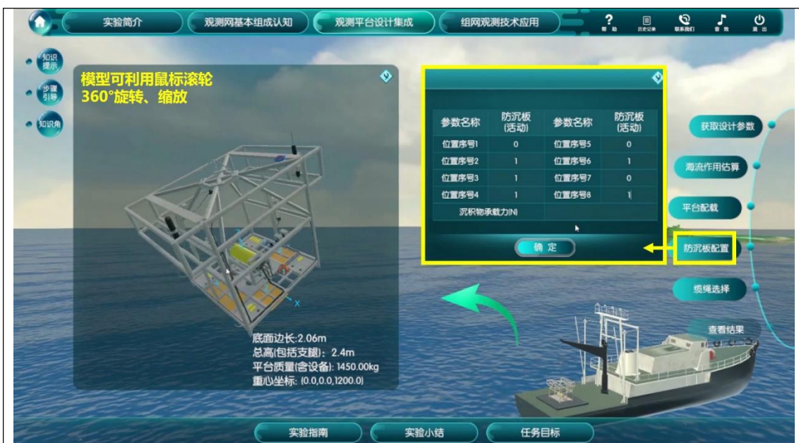
图17b 坐底观测平台防沉板配置
