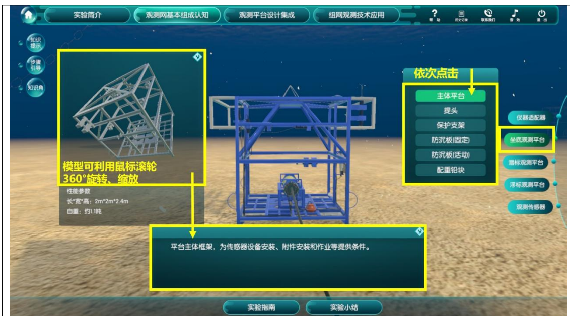
图13c 终端观测系统-坐底观测平台认知
