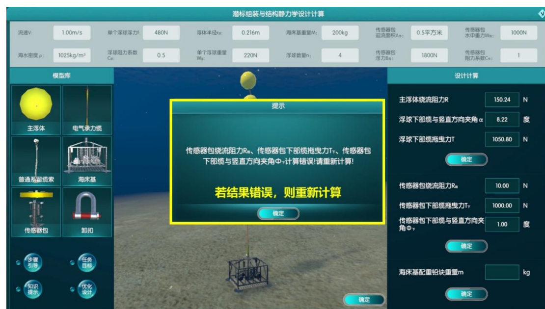
图21b 根据提示重新进行潜标传感器包静力学及姿态分析
