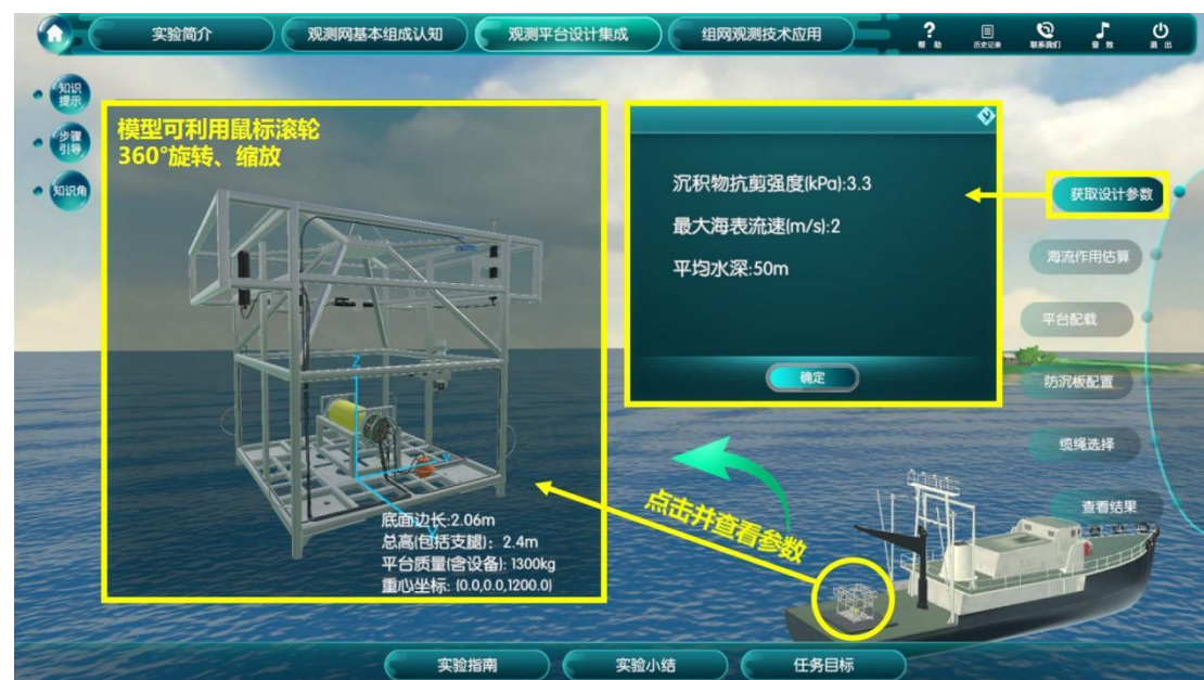
图 15a 坐底观测平台模型观察及设计参数获取
