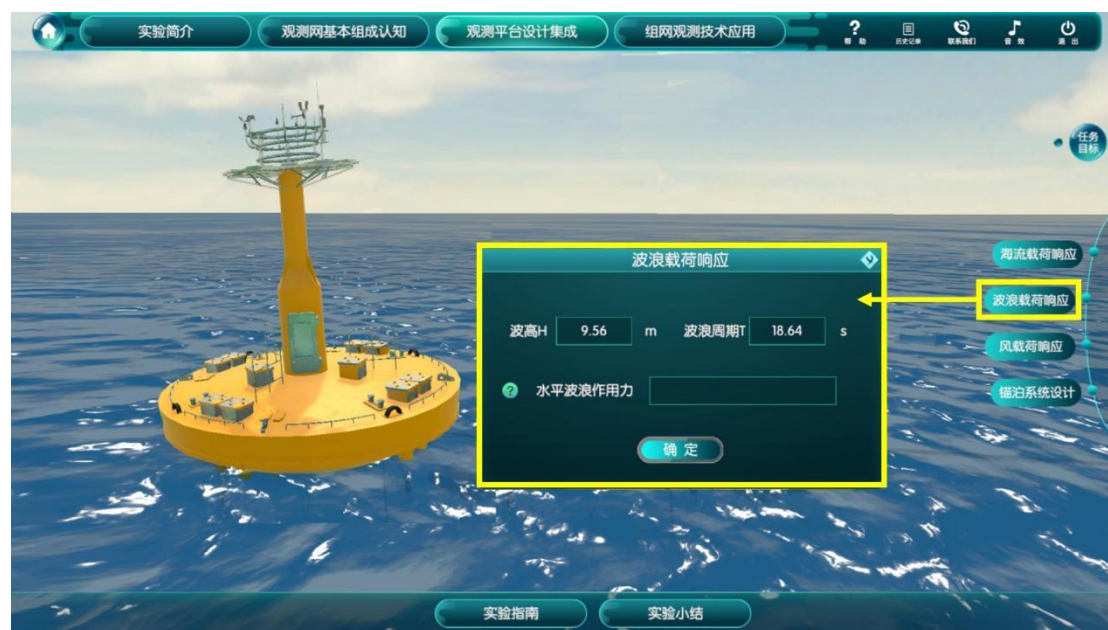
图25b 浮标观测平台波浪载荷响应计算
