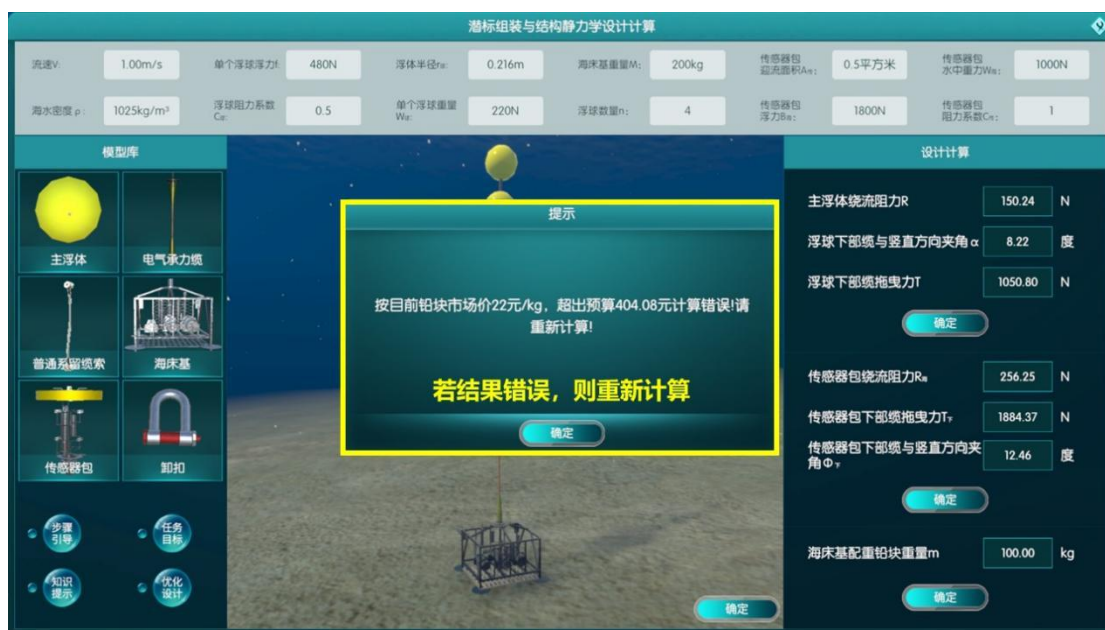
图22b 根据提示重新设计海床基配重
