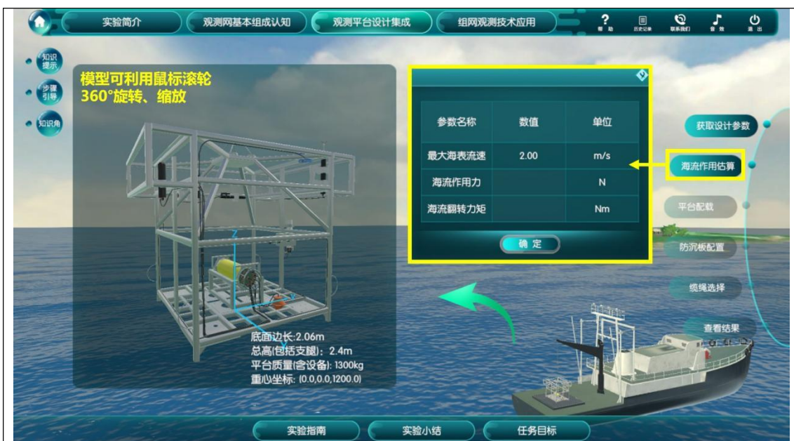
图15c 坐底观测平台海流作用估算
