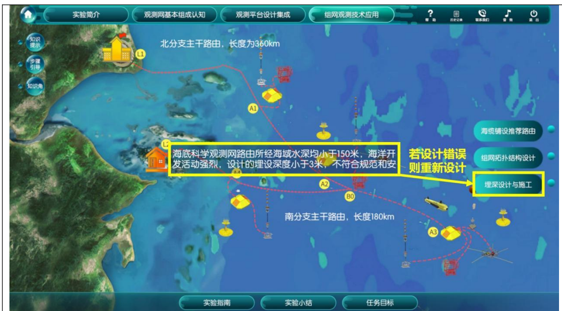
图 30c 若海光缆埋深与施工错误则重新设计
