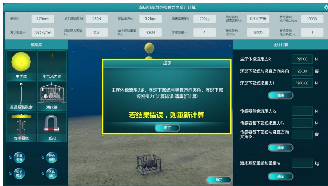
图 20c 根据提示重新进行潜标主浮体静力学及姿态分析
