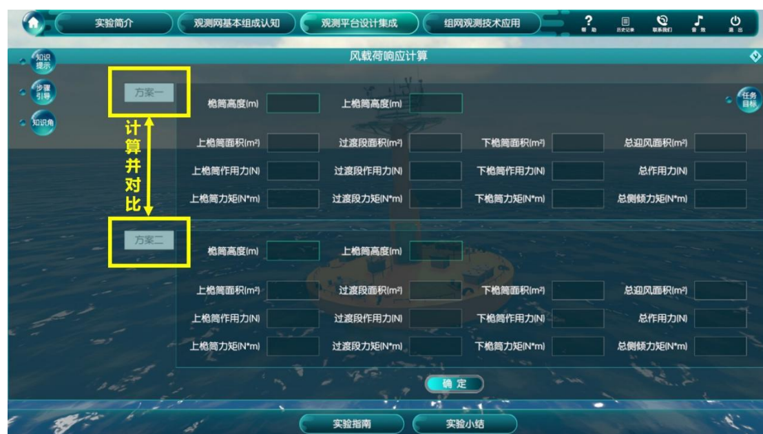
图26b 浮标观测平台风载荷响应计算
