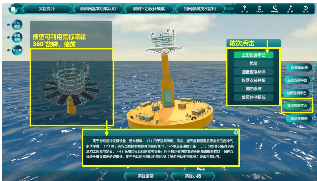
图13f 终端观测系统-观测传感器认知
