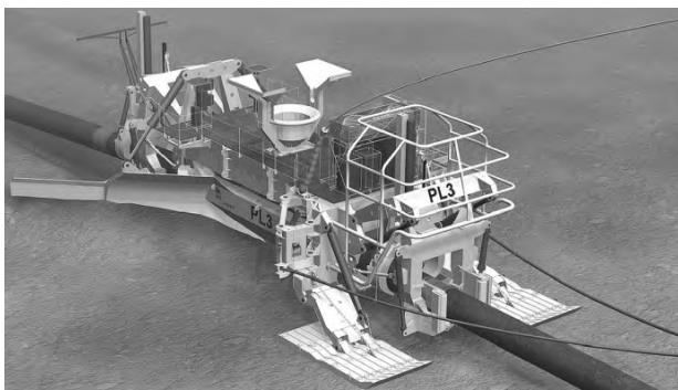
图 2 PLC 开沟犁作业示意图
